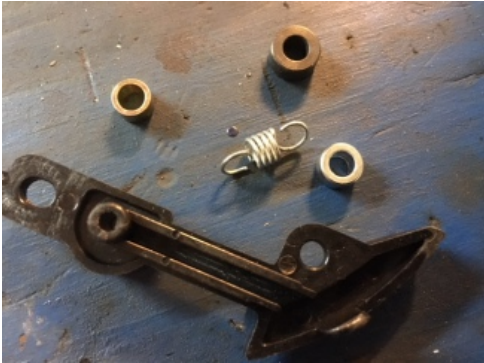
Le système d'avance à l'allumage mécanique de votre moteur FORD 289 302 Ci est composé de ressorts et de masselottes
