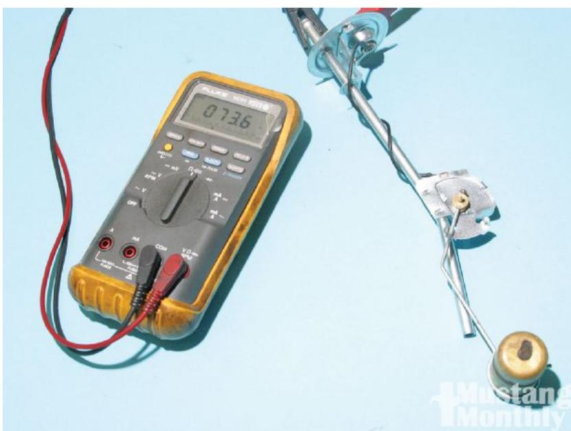
Une sonde de carburant avec un réservoir vide montre 73,6 ohms et l'allumage faible de l'ampoule....
