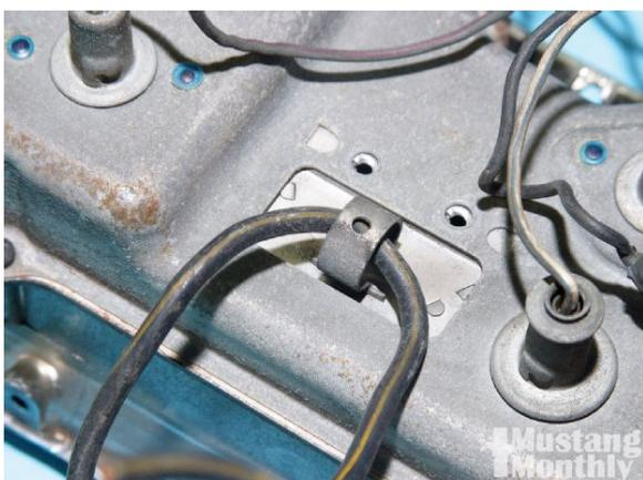
Voici l'ampèremètre à induction de 1965, installé avec le fil d'alimentation principal (37, noir / jaune) qui passe dans la boucle d'induction.
