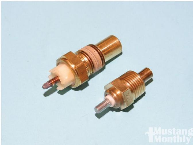
Les sondes de température du liquide de refroidissement varient d'une génération à l'autre.
