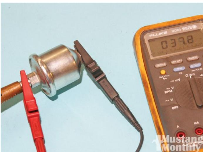
Les sondes de pression d'huile doivent afficher une résistance de 24-36 ohms à 0.55b ou moins et de 8,0 à 17,5 ohms à 6.2b (jauge maximale).
