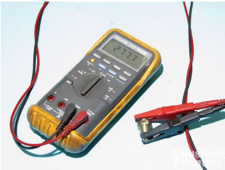
L'essai de résistance de la sonde de température de liquide de refroidissement montre 277.7 ohms à froid, qui est une résistance élevée. La lecture de la jauge serait "C", pour Cold, car il n'y a pratiquement aucun courant qui traverse la jauge.
