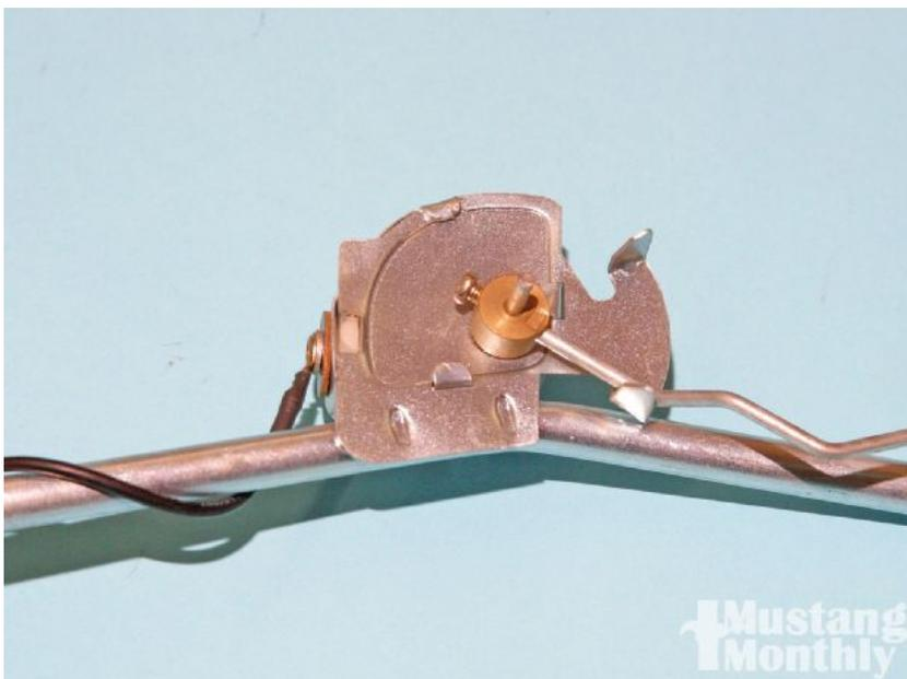
La sonde de carburant peut être étalonnée avec la jauge de carburant. C'est là que nous ajustons la jauge de carburant et la sonde pour obtenir une jauge tip top.
