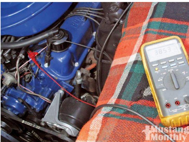
La vérification d'une sonde de température du liquide de refroidissement sur le véhicule indique une résistance de 385,3 ohms ou une résistance élevée.
