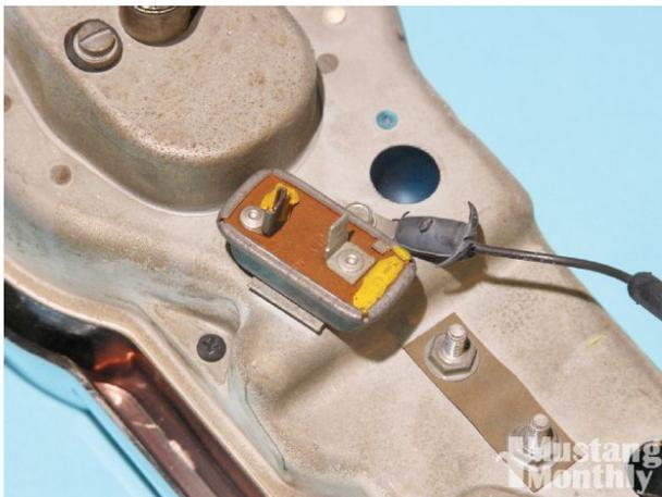
Ceci est le régulateur de tension qui se trouve à l'arrière du tableaux de bord des Mustang.
