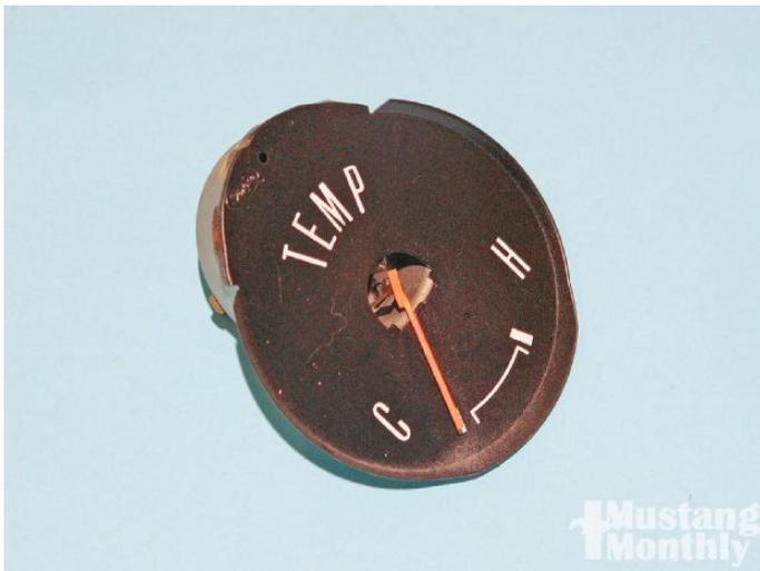
La jauge de température des Mustangs, la jauge de pression d'huile et la jauge de carburant sont identiques à l'intérieur. Seuls les cadrans et les sondes diffèrent.
